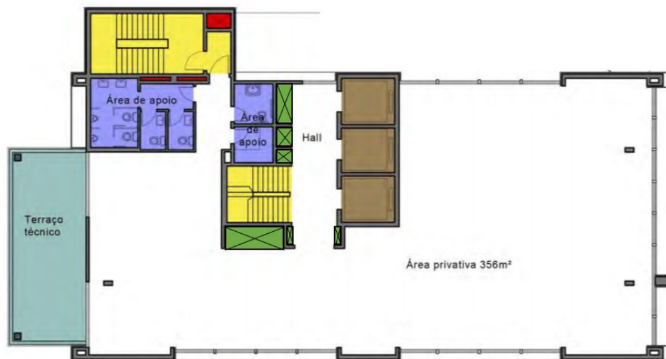
Figura 27 - Planta do Pavimento Tipo do Edifício Paulista 2028: Em verde são representados os novos shafts, em vermelho os shafts existentes.
