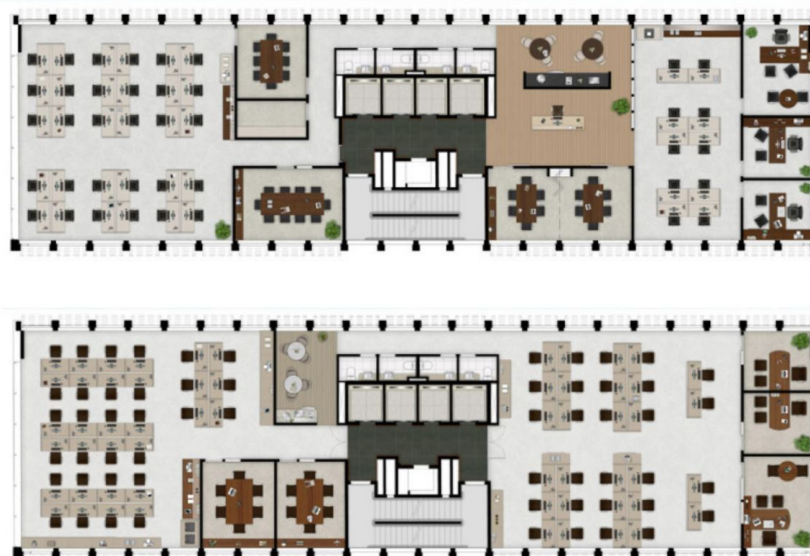
Figura 25 - Plantas do edifício representando duas possibilidades diferentes de layout da laje do pavimento tipo.
